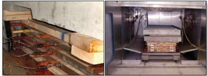
Figure 2 : Dispositif expérimental pour les essais de validation : a) chargement dans le séchoir; b) capteurs de mesure de la pression et de la température dans le bois.
