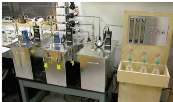
Figure 1: Vue générale des petites chambres d'exposition pour analyser les émissions de formaldéhyde et de COVs.
