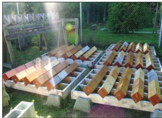
Figure 1 : Tests aux intempéries de spécimens de lamellé-collé revêtus et prétraités au borate; chacun des cinq supports contenait 20 spécimens (10 types de revêtements et deux prétraitements, y compris un spécimen de contrôle non traité; chaque combinaison de traitement et de revêtement a été reproduite cinq fois).
